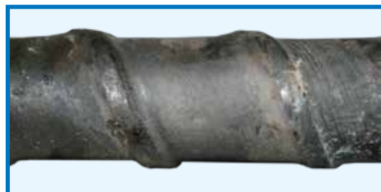
Schroef met afgesleten flanken en geruwde kern
