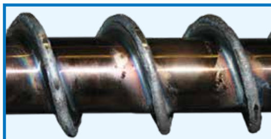
Flanken worden volledig opgelast met de mogelijkheid om hierbij extra slijtvast materiaal toe te voegen
