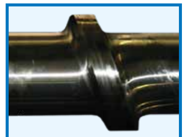
Nitreren, nabewerken, polijsten, richten en de plasticieerschroef is weer als nieuw
